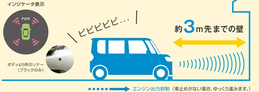
車体の前方と後方に計4カ所のソナーをつけることで、目の前の障害物を検知します。障害物を検知した状態であれば、アクセルを強く踏み込んでしまっても燃料カットされ、急発進を抑制する仕組みになっています(約8秒間エンジン出力を抑えます)。
