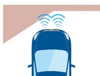
障害物が超音波を反射しにくい素材や形状の時。(生垣、雪、縄状の物、金網や柵など)
