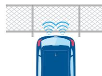
センサーに汚れが付着したり、豪雨/強風などで超音波が妨げられる時。
